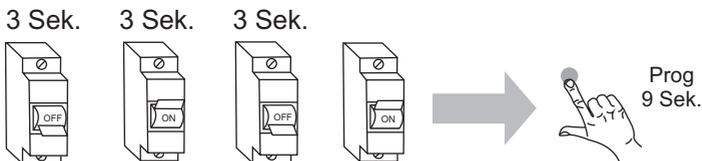
Im Auslieferungszustand sind keine Endpunkte und keine Sender im Antrieb eingelernt! Um den Antrieb in den Auslieferungszustand zurückzusetzen, muss der Antrieb durch die Netztrennung in den Service-Modus gebracht werden.
